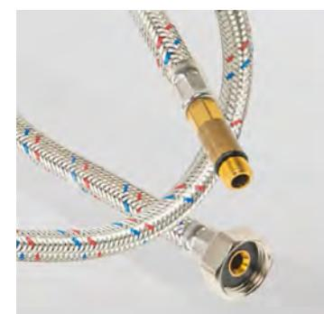
Внутренний шланг **гибкой подводки STOUT** изготовлен из экологичного материала - EPDM (пищевой). EPDM- материал повышенной плотности (монолитный), обеспечивает высокую износостойчивость (большее количество циклов работы). Латунь, используемая в производстве гибкой подводки - пищевая (латунь специальная, ЛС), в ней меньшее содержание Zn, Pb. Высокое качество запрессовки втулки из нержавеющей стали к шлангу дает 100% защиту от протечек.
